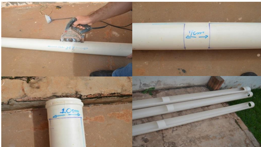
Figura 9. Foto do corte do cano para confecção da calha.
