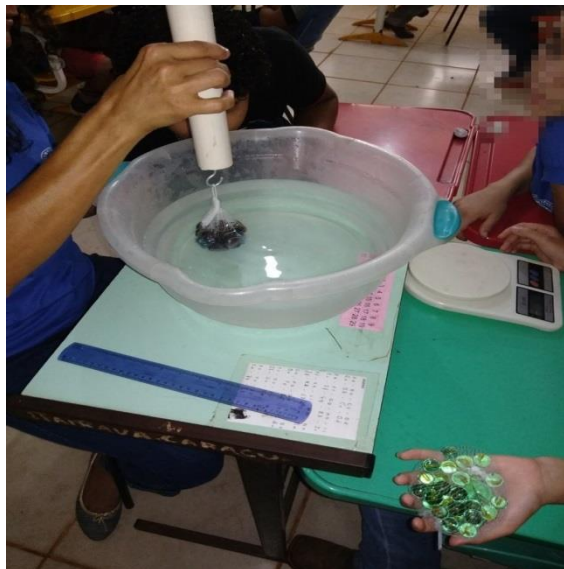
Figura 11 - G1 inserindo o saquinho de bolinhas na água, suspenso pelo dinamômetro
